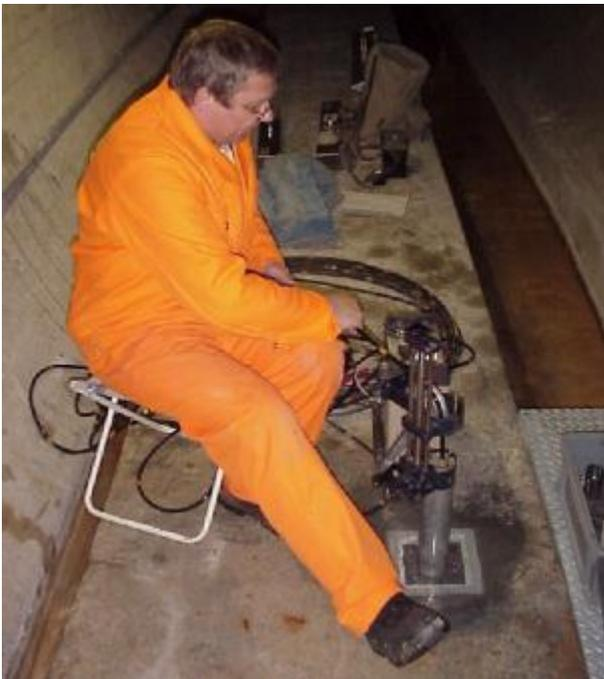
Figure 2.17-3 Exécution d'une mesure avec micromètre de forage muni d'une sonde à induction sans contact
