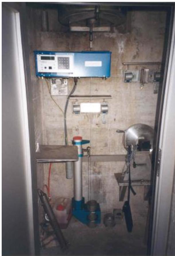
Figure 2.09-1: Pendule inversé avec système de centrage mobile et enregistrement automatique
