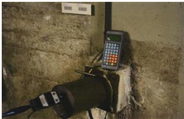
Figure 2.14-3: Appareil digital de mesure monté sur une tête de mesure avec déflexomètre et identification du point de mesure
