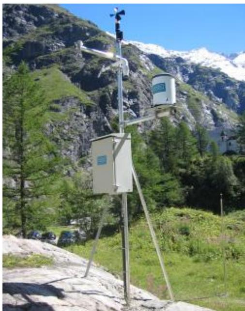
Figure 1.16-1: Pluviographe avec auget à bascule
