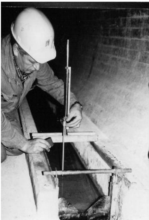
Figure 3.02-01: Déversoir avec aiguille de mesure
