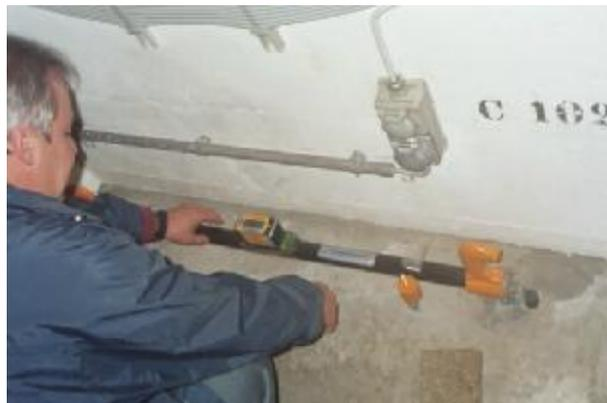
Figure 2.19-2: Ajustement mécanique d'un inclinomètre en vue de l'exécution d'une mesure
