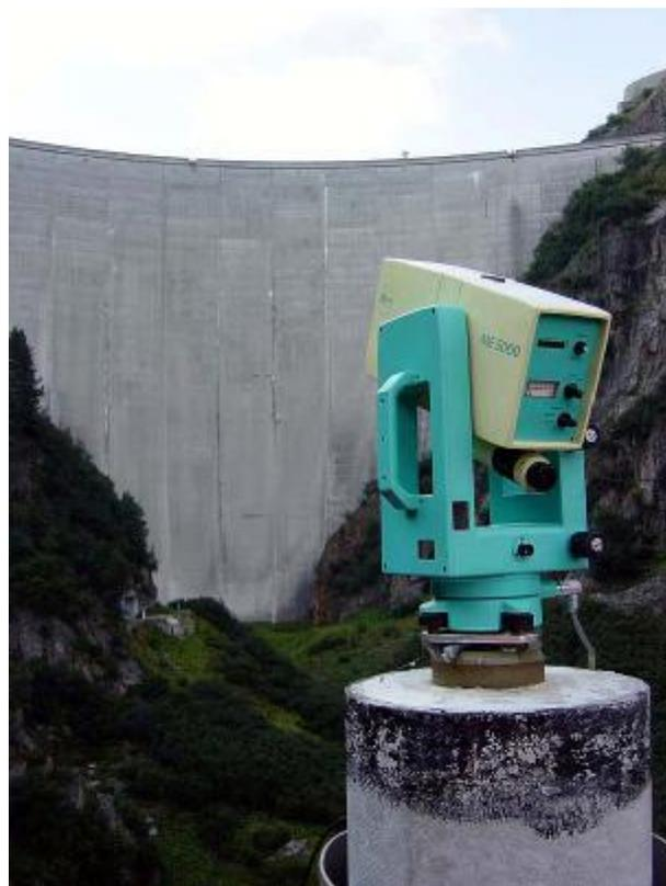
Figure 2.01-2: Instrument de précision de mesure de distance ME5000
