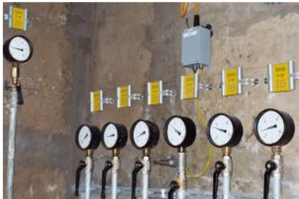
Figure 3.06-8: Mesure de la sous-pression au moyen d'un système fermé avec des points de mesure répartis d'amont vers l'aval. La valeur de la pression du 3<sup>e</sup> manomètre depuis la droite est transmise à distance
