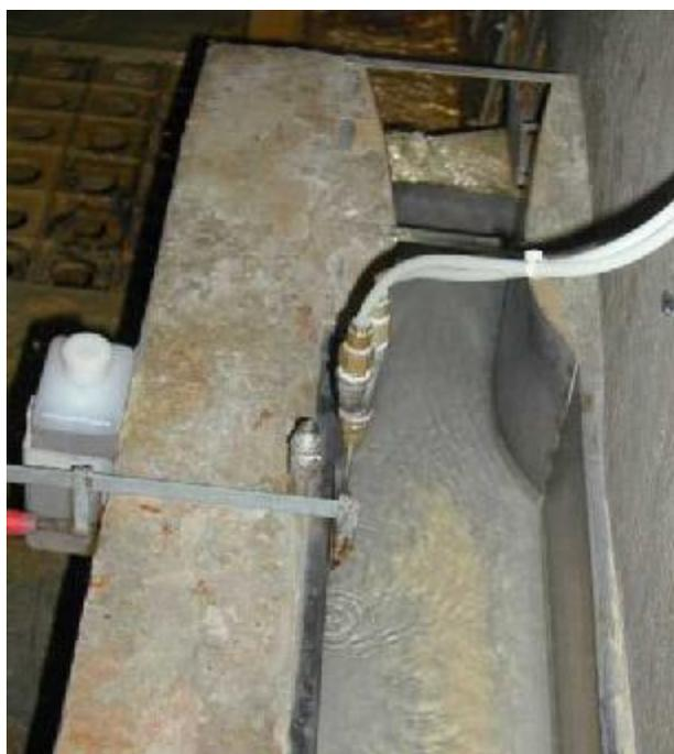
Figure 3.02-3: Canal de mesure avec Venturi. Mesure avec entraînement de bulles d'air
