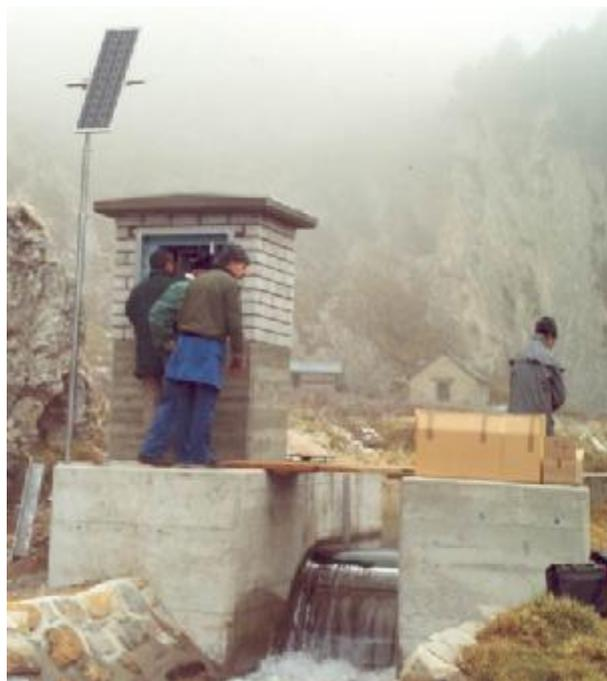
Figure 3.02-4: Station de mesure automatique pour débits importants
