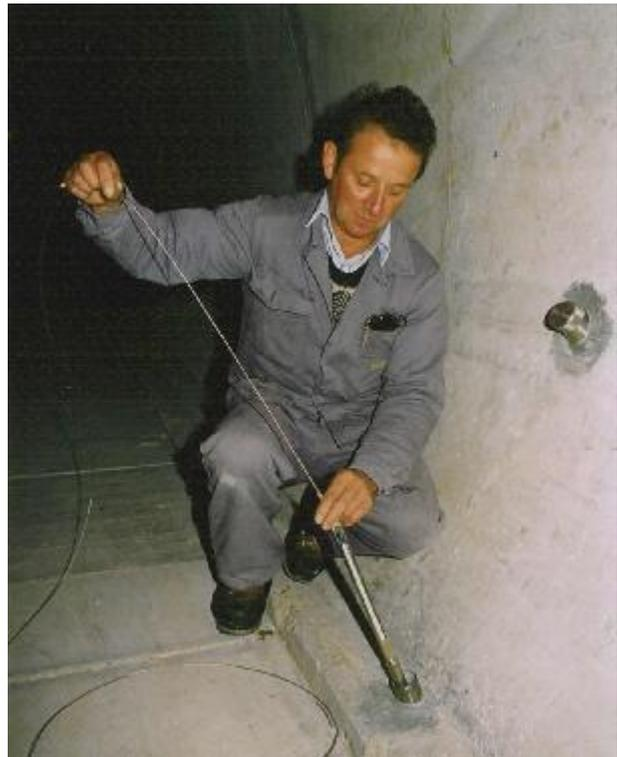
Figure 1.13-1: Introduction d'un thermomètre normal dans un forage
