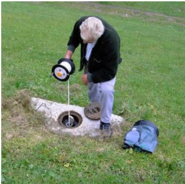
Figure 3.05-2: Mesure du niveau d'eau dans un tube piézométrique au moyen d'un câble avec témoin lumineux
