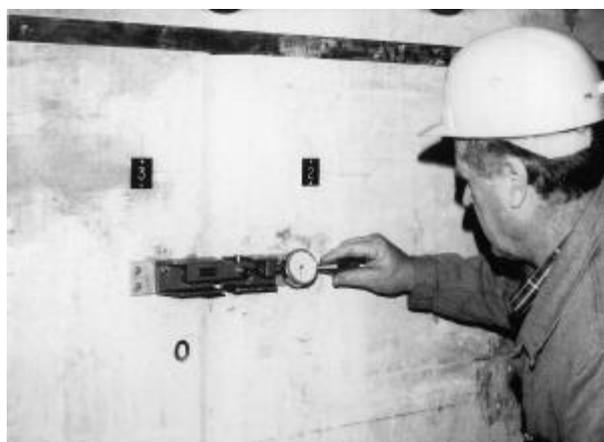
*Figure 2.20-3: Mesure analogique du mouvement d'un joint dans 3 directions*
