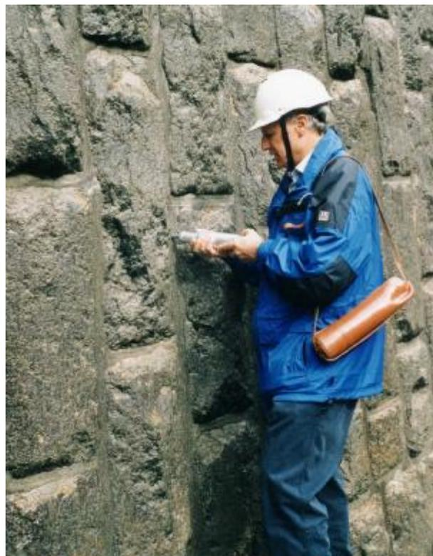
Figure 4.04-2: Exécution d'une mesure sclérométrique
