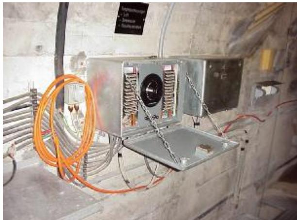
Figure 1.14-1: Station de mesure des températures du béton
