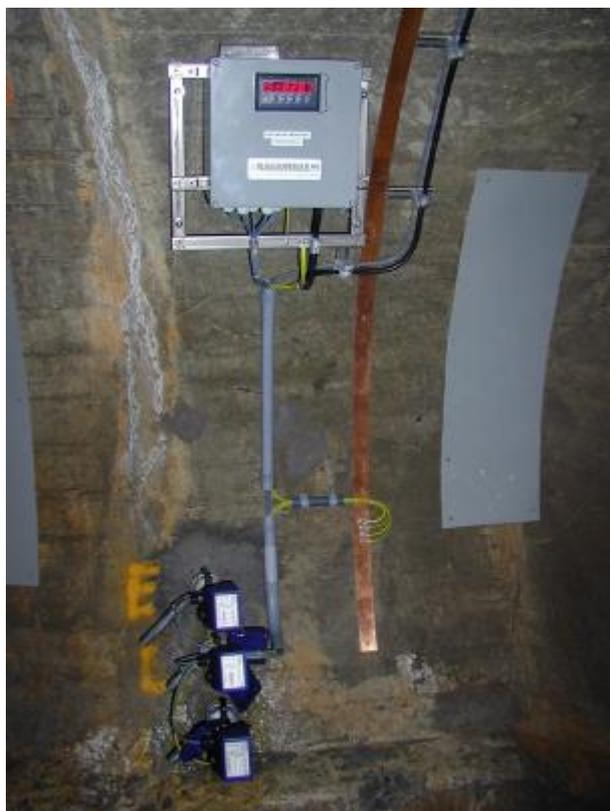
Figure 3.06-9: Système fermé avec capteurs électriques de pression avec transmission à distance placés en tête de forage pour éviter des pertes de pression
