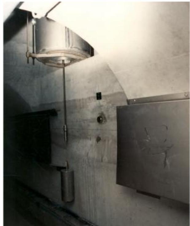
Figure 2.10-2: Suspension intermédiaire d'un fil au moyen d'un flotteur
