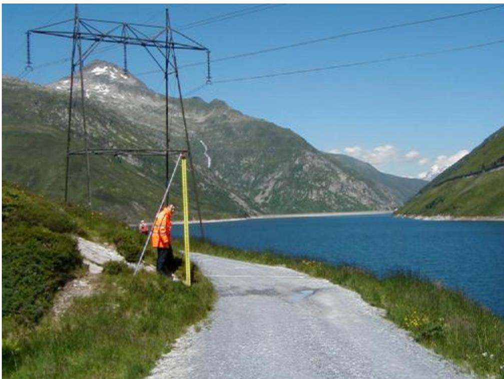
Figure 2.05-2: Mire de nivellement de 3 m
