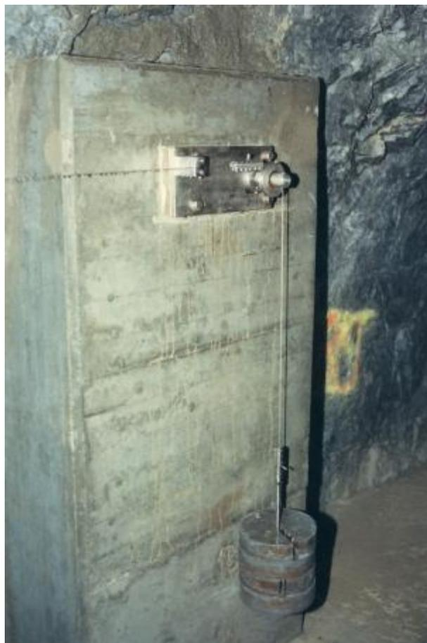
Figure 2.10-5: Point fixe d'alignement avec poids tendeur
