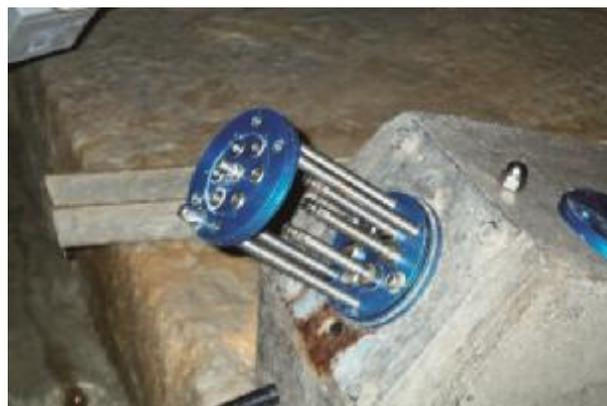
Figure 2.14-4: Tête de mesure avec 3 tiges
