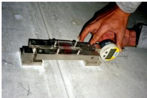
Figure 2.20-2: Appareil de la mesure d'un dans 3 directions qui chacune peut être mesurée des 2 côtés du joint (mesure digitale)
