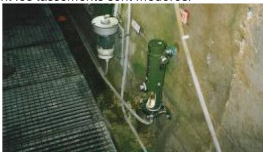
Figure 2.12-2: Repère de tassement hydraulique dans la fondation d'un barrage en béton
