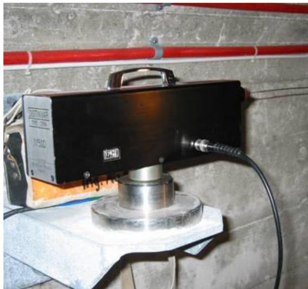
Figure 2.13-2: Distinvar monté sur une console pour la mesure de tronçons de polygonale dans une galerie de barrage
